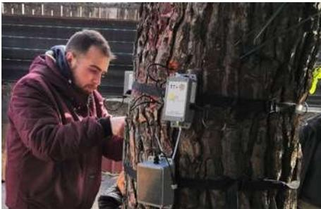
Sono stati effettuati dei **test sperimentali** finalizzati alla **calibrazione della sensoristica** deputata alla misurazione del **sapflow**.
