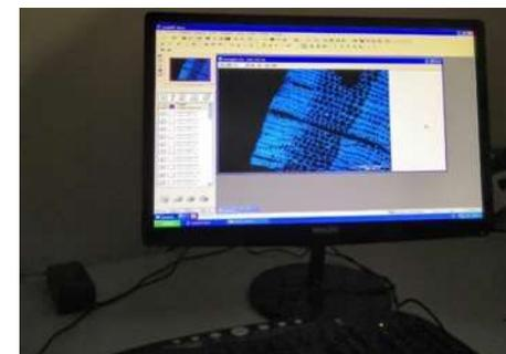
Le sezioni sono **montate su un vetrino**, e attraverso un **microscopio** sono **censite** le **cellule xilematiche** nelle diverse fasi di differenziazione.
