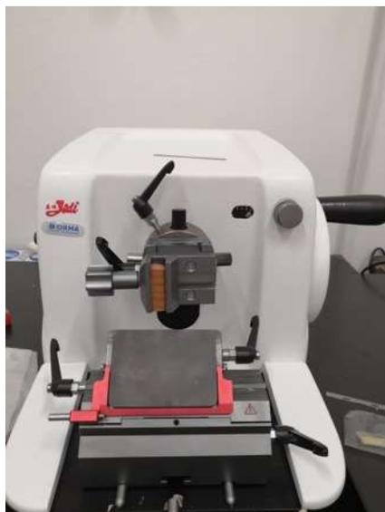
Sono state ottenute **sezioni trasversali di 10 µm** mediante un **microtomo** rotativo
