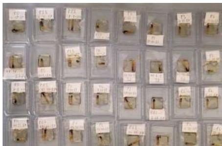
Dopo essere **fissate nella resina**, dalle microcarote sono ottenute delle **sezioni trasversali** sottili mediante un **microtomo rotativo**.
