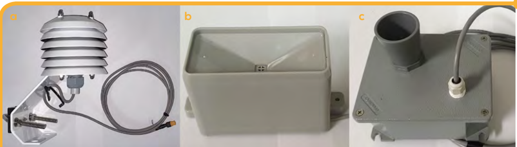
Figura 1 - Dettagli di alcune delle componenti fondamentali della stazione meteo AForClimate: a) sensore per la misurazione di temperatura e umidità relativa dell'aria; b) sensore per la misurazione della pioggia; c) sensore per la misurazione del livello della neve.
