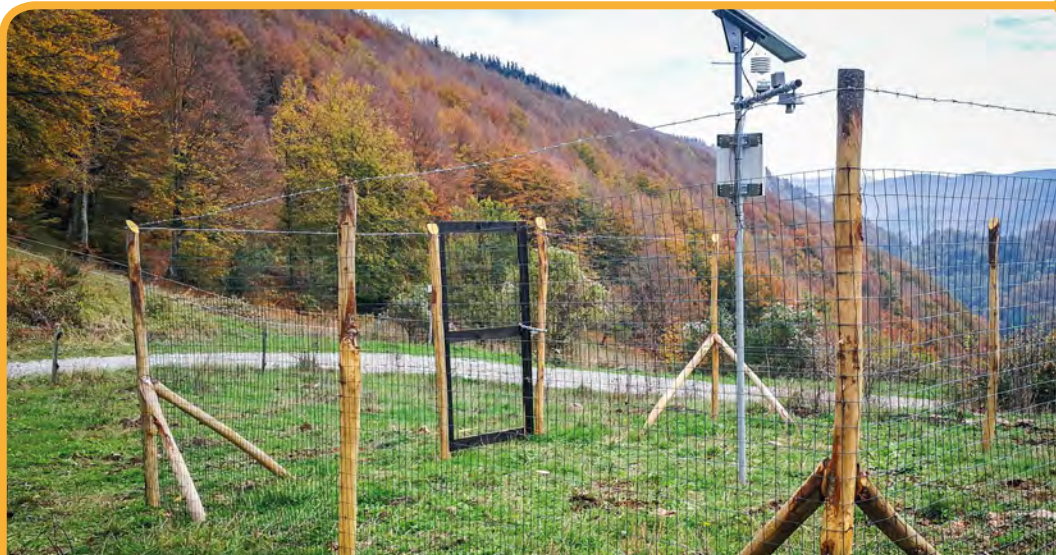
Una delle quattro stazioni meteo AForClimate installate in prossimità delle faggete nell'area dimostrativa del Mugello (Toscana). Ogni stazione è stata protetta da una recinzione per evitare danneggiamenti.
